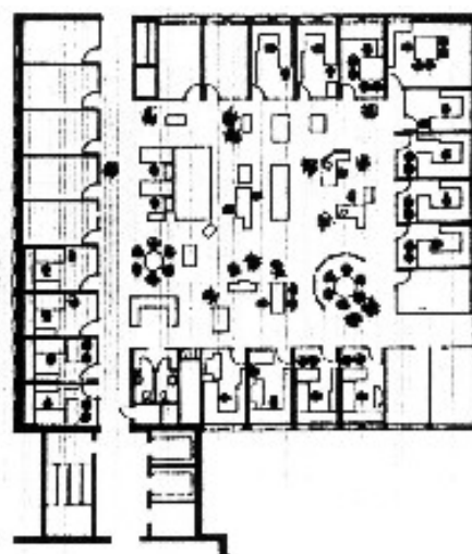
Fig.18: Espaço combinado ( Combi Office ) Fonte: Worthington, 1997:34
